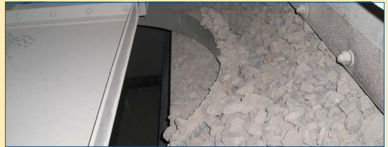
Block – Bunker Discharge Machine / Wózek do rozładunku bunkrów – budowa blokowa
